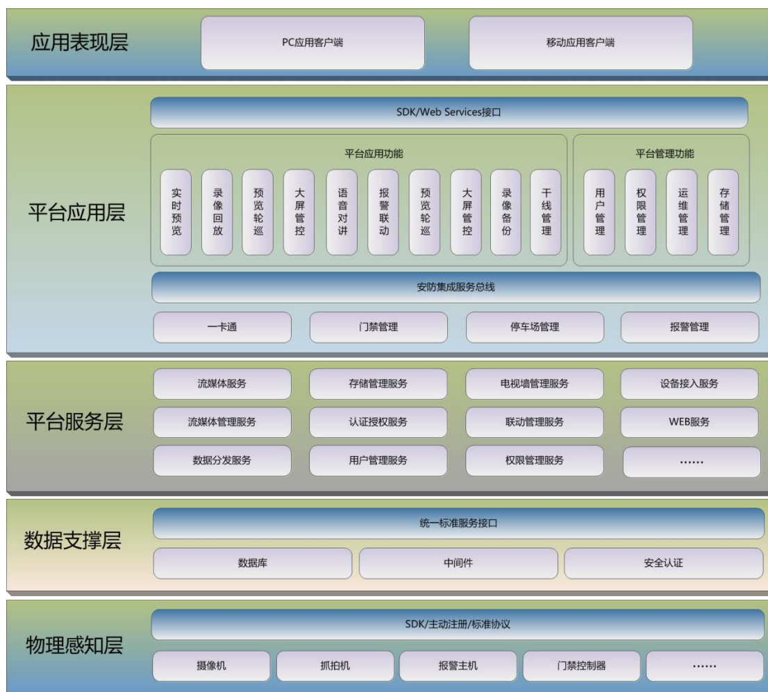
图 9. 综合安保管理平台技术架构示意图
