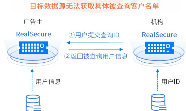
图 8 匿踪查询流程图
