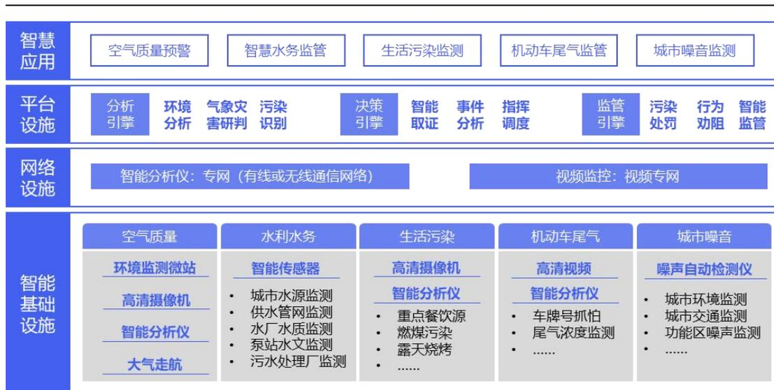
图 3.16 智慧城市环境监管数字化基础设施建设架构
