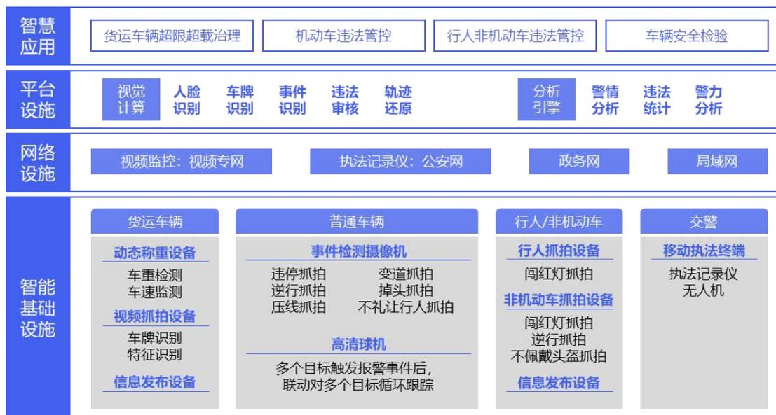
图 3.3 智慧交通非现场执法数字化基础设施建设架构
