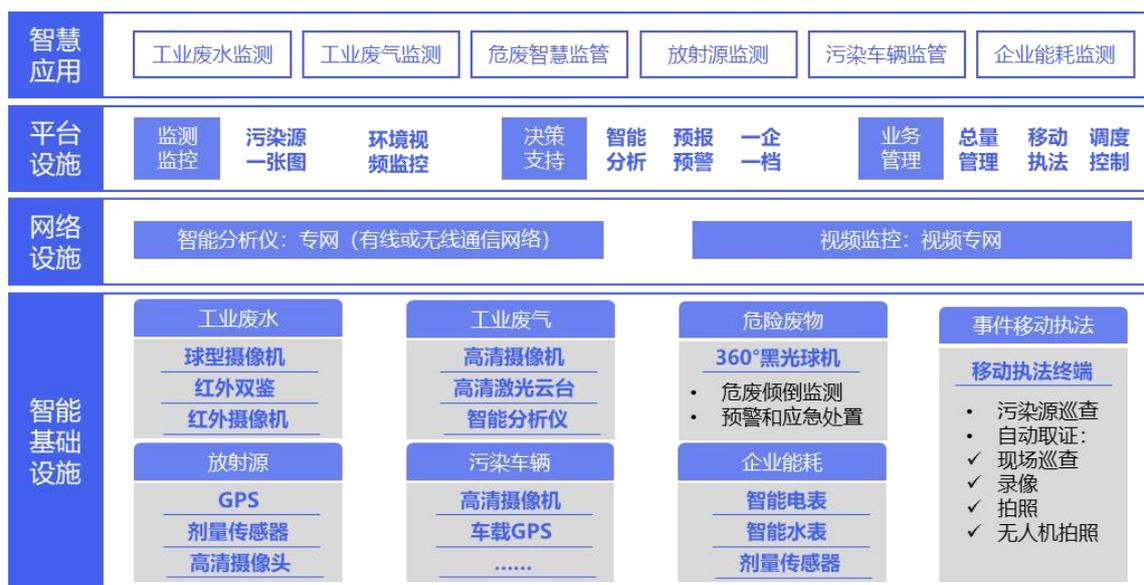
图 3.15 智慧污染源监管数字化基础设施建设架构
