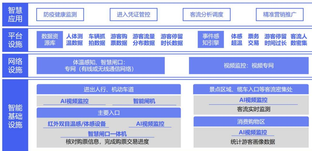
图 3.11 景区综合运营数字化基础设施建设架构
