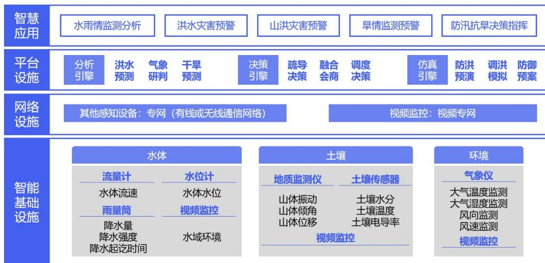
图 3.23 智慧汛旱灾害防御数字化基础设施建设架构
