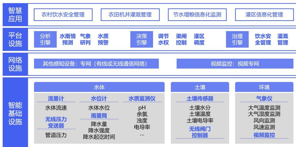
图 3.26 智慧农村水利数字化基础设施建设架构
