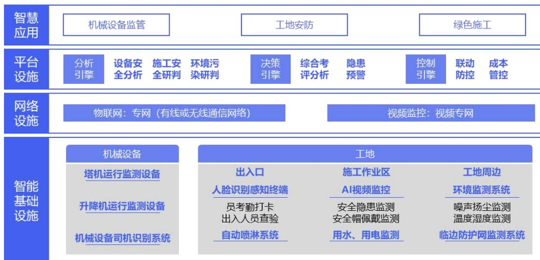
图 3.21 智慧工地数字化基础设施建设架构
