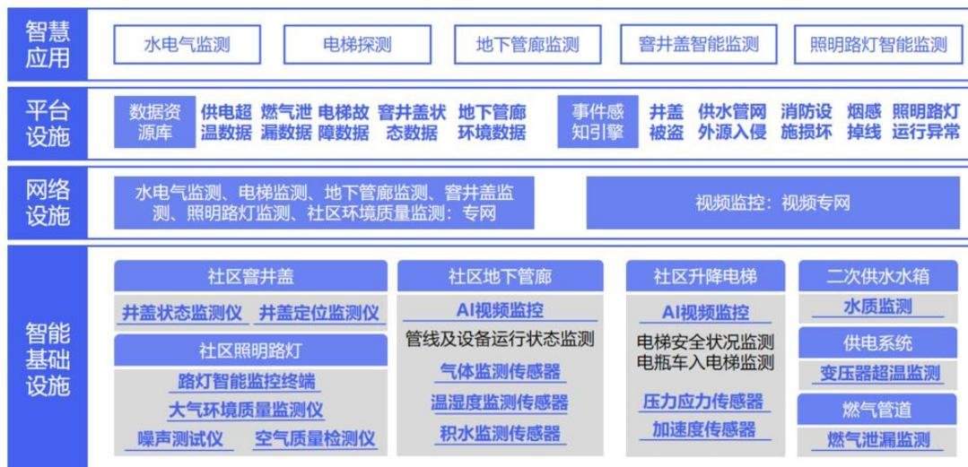
图 3.8 重点设施监管数字化基础设施建设架构
