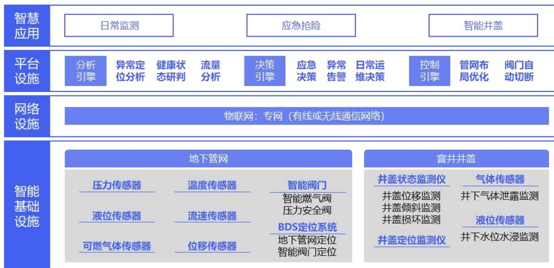
图 3.19 智能管网数字化基础设施建设架构
