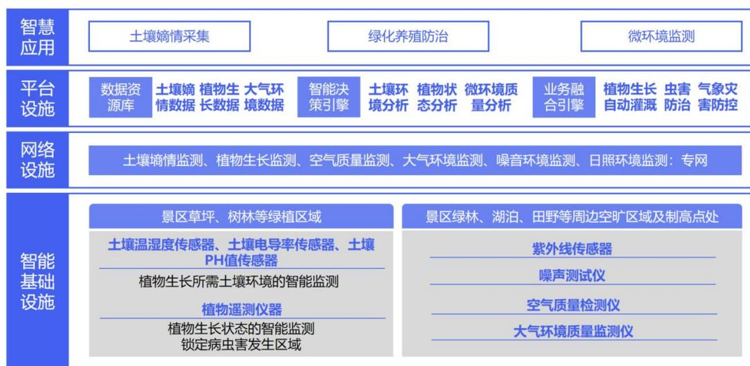
图 3.13 景区绿植养护数字化基础设施建设架构
