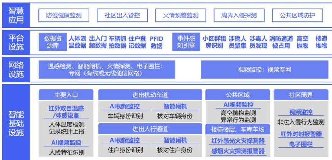
图 3.7 智慧安全防护数字化基础设施建设架构
