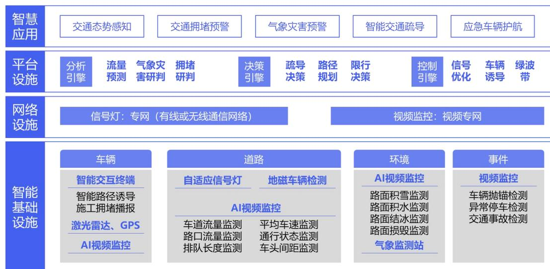
图 3.1 智慧交通治堵数字化基础设施建设架构
